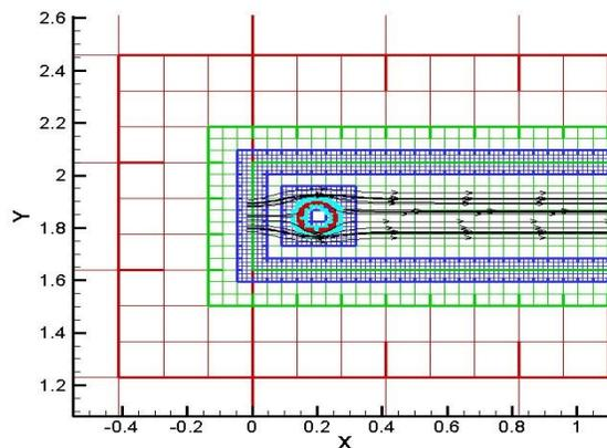
Die einzelnen Levels werden in verschiedenen Farben dargestellt. Die Richtungen der Geschwindigkeitsvektoren werden mittels Streamtraces von Tecplot angezeigt.
