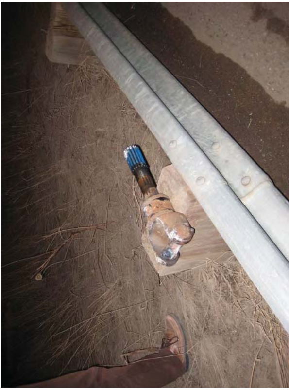
Abbildung 5: Ausbremsendes Metallteil aus dem Antriebsstrang eines LKW
