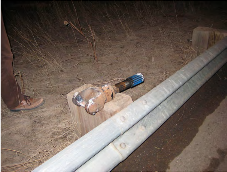
Abbildung 5: Ausbremsendes Metallteil aus dem Antriebsstrang eines LKW
