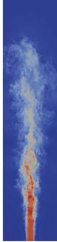
Abb. 2: Simulation eines Düsenstrahls mit dem MRT Lattice-Bolzmann-Verfahren auf 65536 Kernen.
