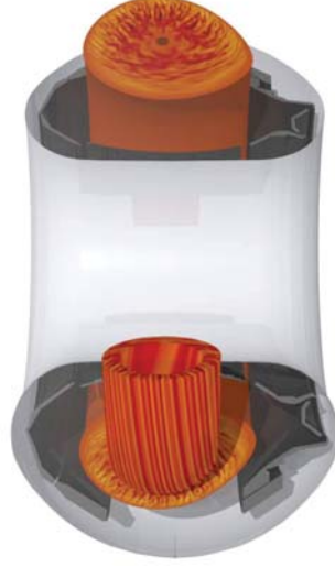
Abbildung 1: GENE-Simulation von Turbulenz im Garching Fusionsexperiment ASDEX Upgrade. Dieses Phänomen führt dazu, dass der ringförmige Magnetfeldkäfig das 100 Millionen Grad heiße Wasserstoff-Plasma nicht perfekt einschließen kann.
