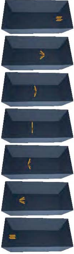
Abbildung 1: Bewegungsmuster von vier fallenden Sphärozyklindern in Stokes-Strömungen.
