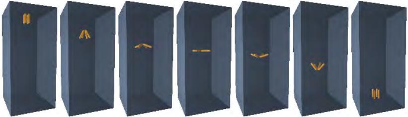
Abbildung 1: Bewegungsmuster von vier fallenden Sphärozyklern in Stokes-Strömungen.
